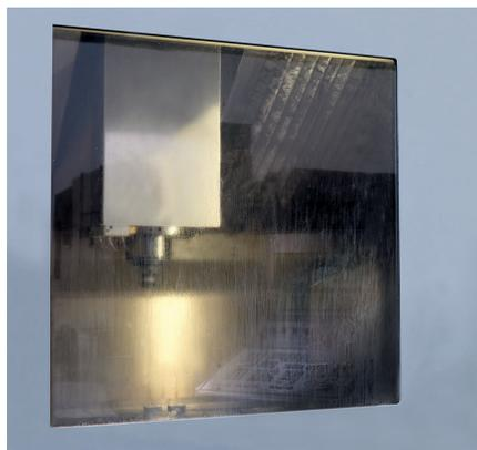
1 Mit der Zeit verlieren ungeschützte PC-Scheiben einen Großteil ihrer Rückhaltefähigkeit. Der Austausch sollte regelmäßig im Rahmen der Wartung erfolgen. Sind sichtbare Schäden erkenntlich (Bild rechts), ist umgehend ein Scheibenwechsel angebracht © Hema
